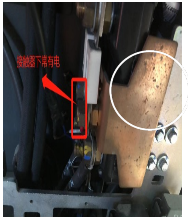
2、设备取电，可从接触器取常电，下测有公共负极（设备工作电压12-80V）
