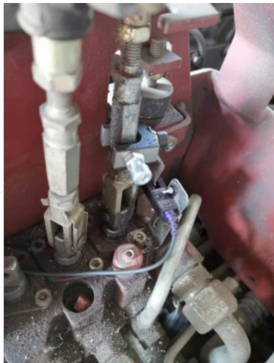
起升光电开关安装示意
