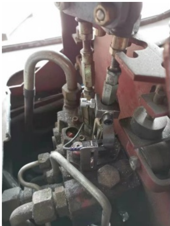
起升光电开关安装示意
