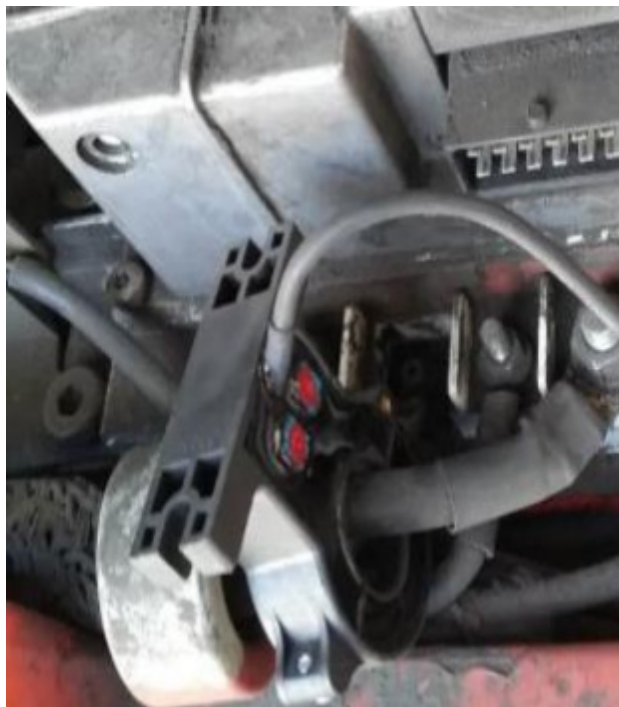
起升液压霍尔传感器（朝电机输入方向区分交直流）
