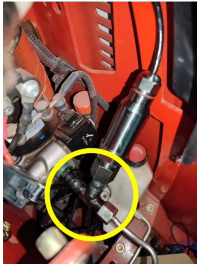
压力传感器和三通安装示例
